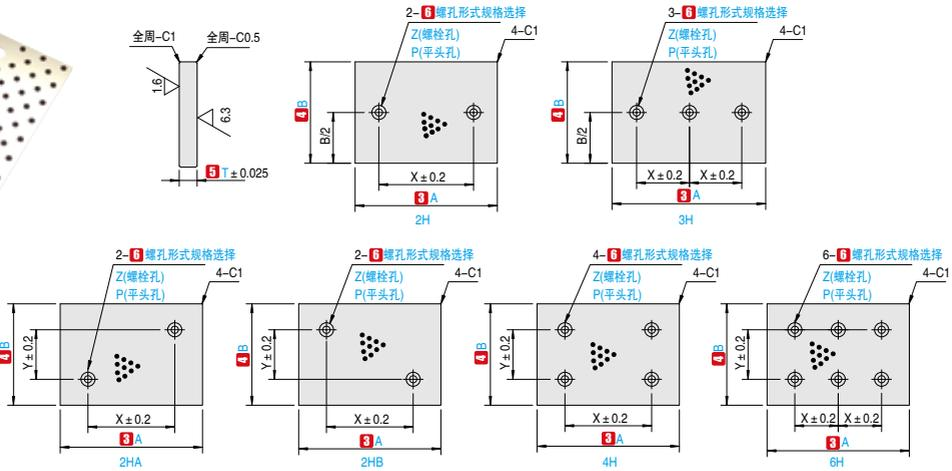
订购编号示例: 1 代号 - 2 规格 - 3 A (长) - 4 B (宽) - 5 T (厚度) - 6 螺孔形式规格
